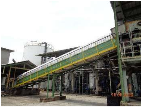
ภาพที่ 2.2-7 อุปกรณ์ปิดครอบสายพานลำเลียงอย่าง มิดชิด
