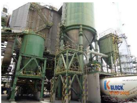
ภาพที่ 2.2-29 ไซโลเก็บเล้าเหาแบบปิด
